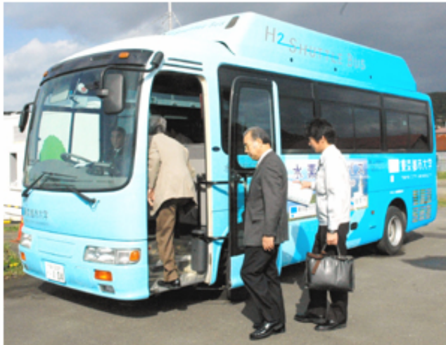
実証走行試験が始まった水素燃料バス。屋根に水素タンクを搭載している＝室蘭市
